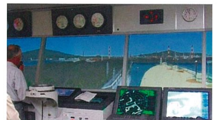
大型LNG船入港に伴う ビジュアル式操船シミュレータ実験
