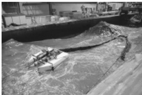
【写真4】 集油ブームを自動的に展張するブイの実験
