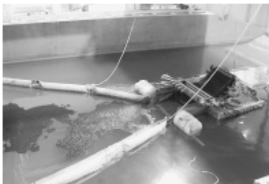
【写真2】 ネット式コンベアを用いた油回収機の実験
