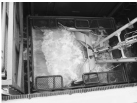
【写真3】 「いしづち」に搭載した真空吸引式油回収機のスキマヘッド
