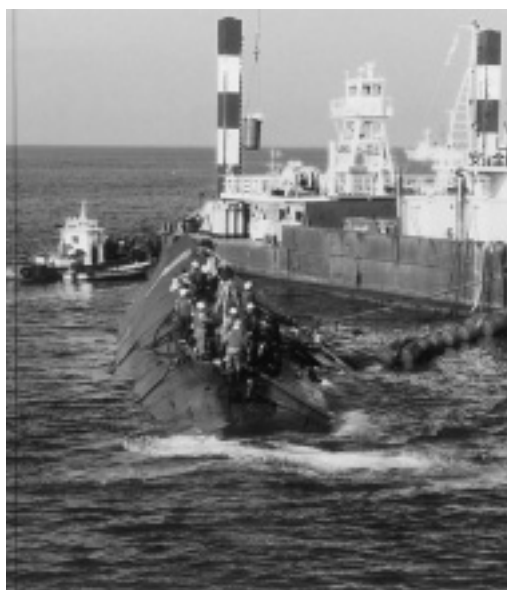
海上からのナホトカ号船首部内の重油抜き取り作業
