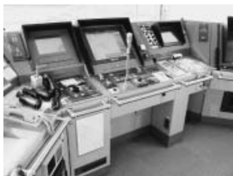
【図4】航海支援システムの搭載状況
