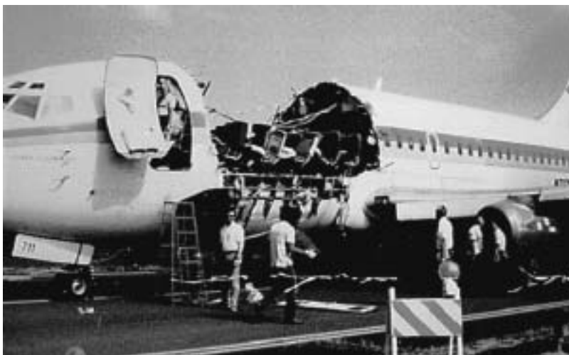
胴体前方の上半分が剥離した B737型機 ( FAA, Human Factors Guide1996から )
