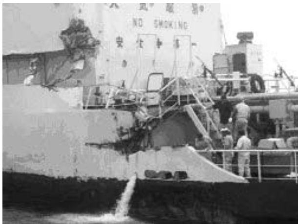
右舷外板部と水面下の燃料タンクに損傷を受けた「三王丸」(446トン)
