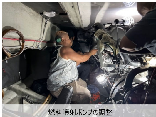
現地職員による燃料噴射ポンプ取外し作業
