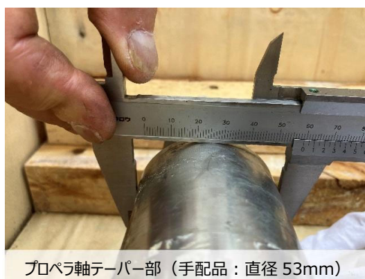
プロペラ軸振動状況確認②
