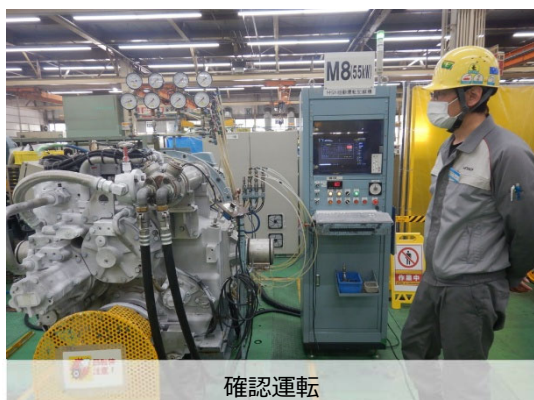
出力軸オイルシール摺動部点検
