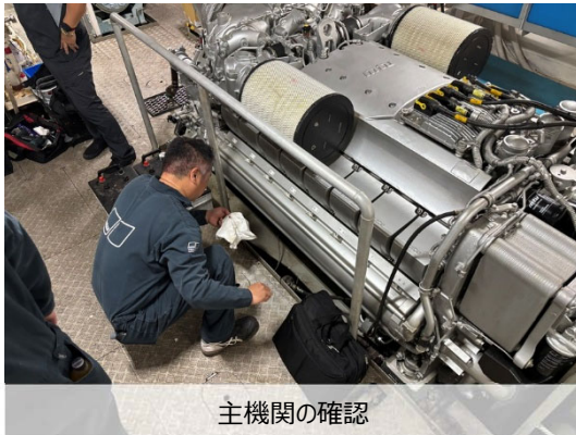
海上試運転にて機関の状態の確認
