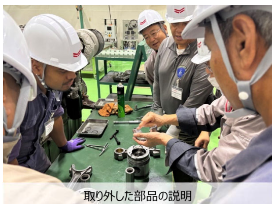
シリンダーヘッド・各パーツ取外し
