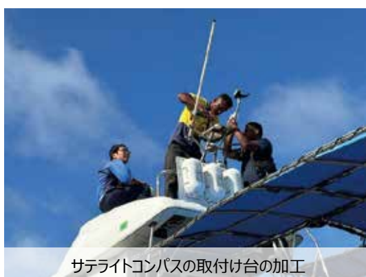
レーダー搭載用ゲートマスト設置
