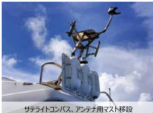
サテライトコンパス、インマルサット、レーダー移設
