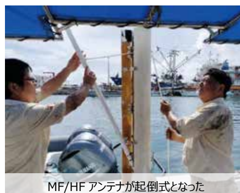
アンテナ支柱を扉式に加工
