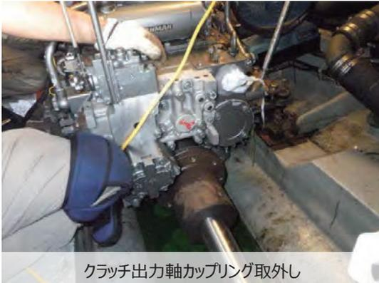
クラッチ出力軸カップリング取外し
