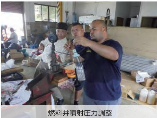
燃料弁噴射圧力調整
