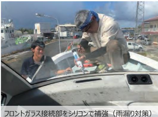
フロントガラス接続部をシリコンで補強（雨漏り対策）
