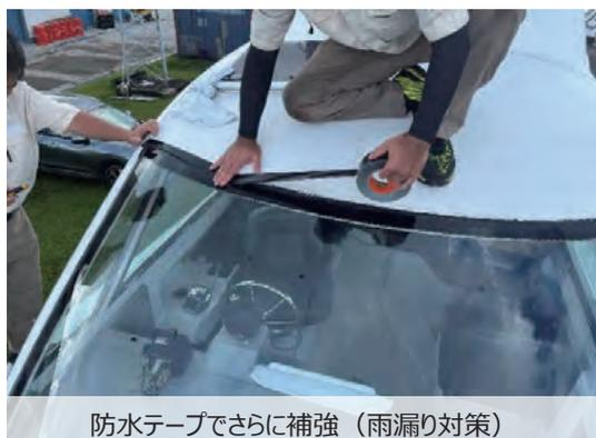
防水テープでさらに補強（雨漏り対策）
