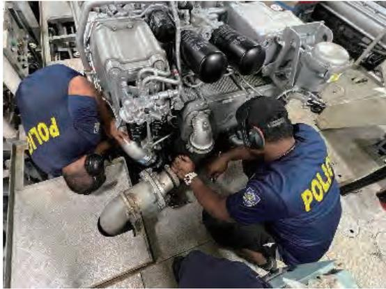
冷却清水圧力センサー点検
