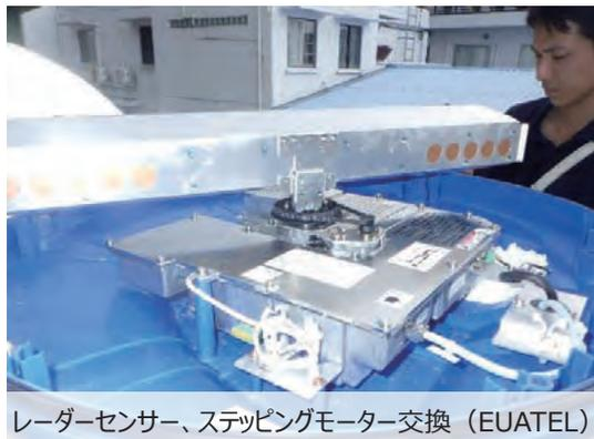
レーダーセンサー、ステッピングモーター交換 (EUATEL)
