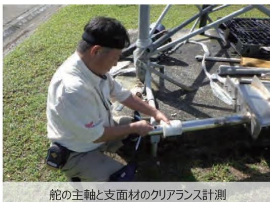
舵の主軸と支面材のクリアランス計測
