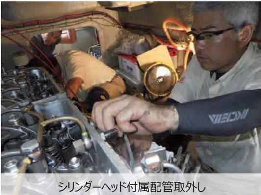
シリンダーヘッド付属配管取外し
