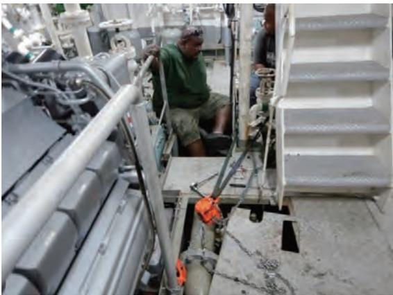
配管・弁取外し整備
