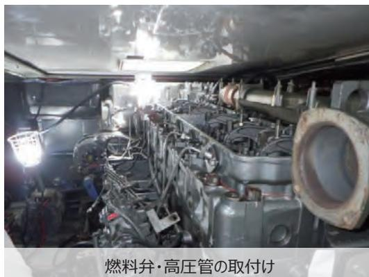
燃料弁・高圧管の取付け
