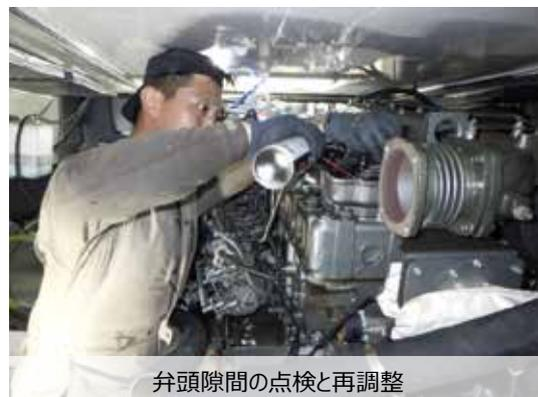
弁頭隙間の点検と再調整
