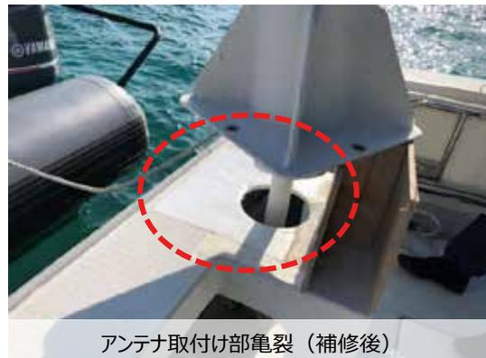
アンテナ取付け部亀裂（補修後）
