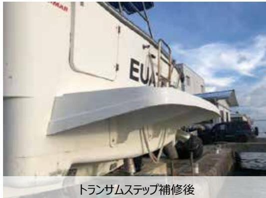
トランサムステップ補修後
