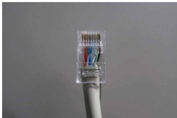
LAN ケーブルの補修（RJ45 プラグ取付）
