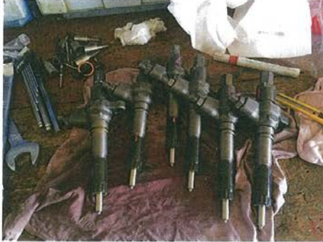
燃料噴射弁ノズル交換
