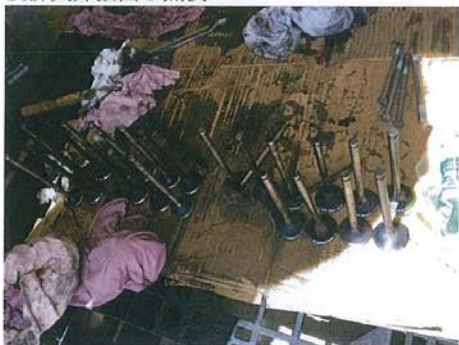
吸排気弁抜き出し点検
