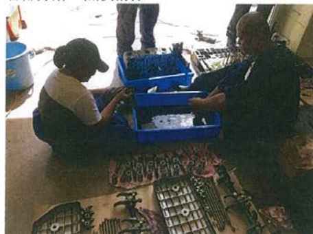
各部分解・点検清掃
