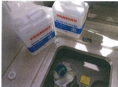
防錆剤交換及び清水張り込み
