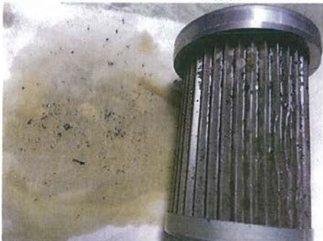
座礁後 減速機ストレーナー点検
