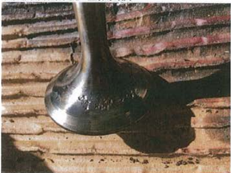
吸気弁腐食確認 全数交換
