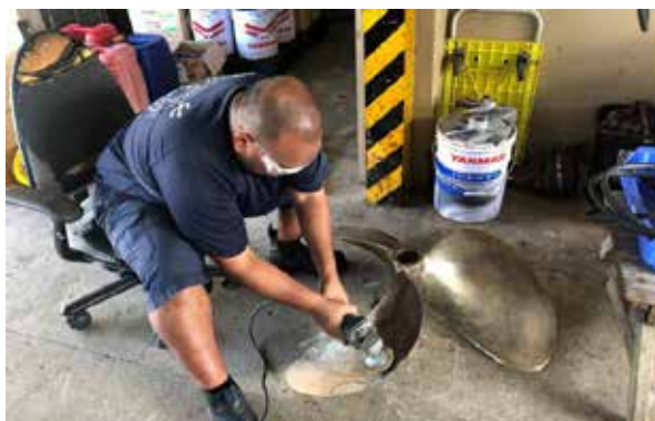
損傷したプロペラの研磨
