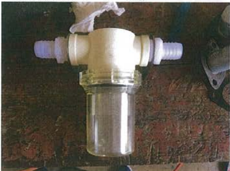
空調用海水ストレーナー交換
