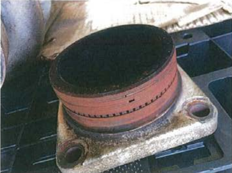
出口管シールリング部清掃
