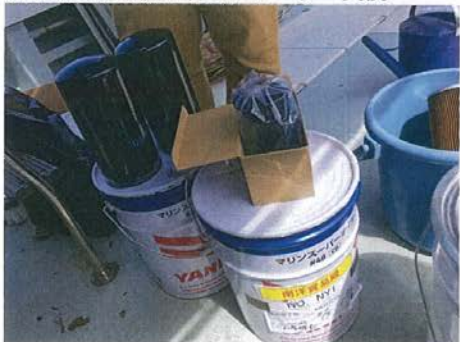
新油張り込み及び各ストレーナー交換
