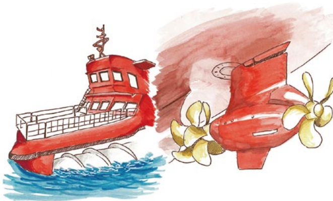
ガリンコⅡとダブルアクション船のポッド型電気推進装置
