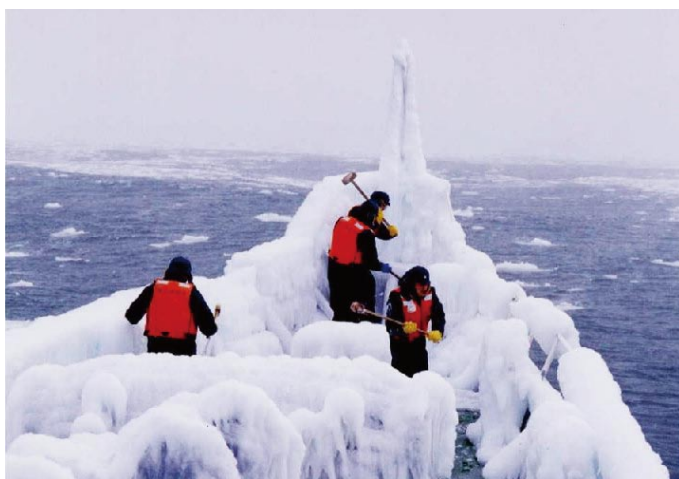
着氷除去作業の様相（第一管区海上保安本部提供）
