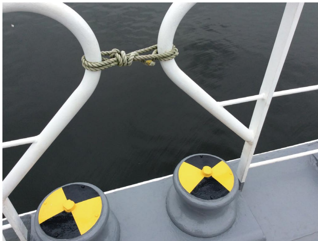
写真 3-1-9 ハンドレールの隙間には危険を知らせる目印を
