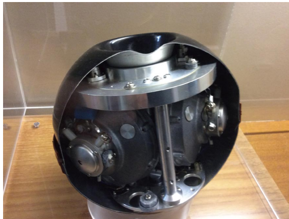
写真 3-1-4 ジャイロコンパス本体の断面模型
