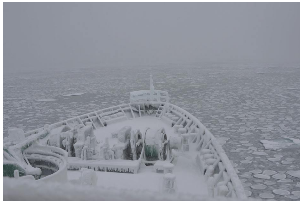
写真 4-1-4 船体着氷による船体等への影響に注意 (錦山一孝氏 提供)
