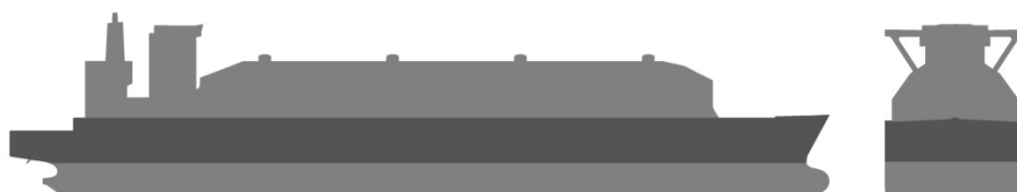
図 3.2.2 モス型（連続型タンクカバー） LNG 運搬船
