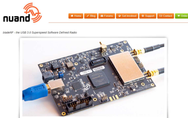
図 3 ソフトウェア無線デバイス（nuand 社 bladeRF）
