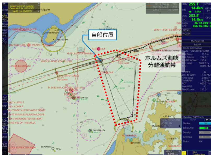
Spoofting 事例 1：ホルムズ海峡分離通行帯を抜けペルシャ湾内を西航中、偽の位置情報を表示 結果的に異常な航跡（画面中央赤破線枠内）となっている アラーム発生なし
