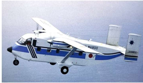
スカイバン（MA800） 積載量を最大限取るため機体が箱型で、 “ハコフグ” という愛称で親しまれていた。 ランディングギアは固定で収納できない。 出典：写真録 海上保安庁
