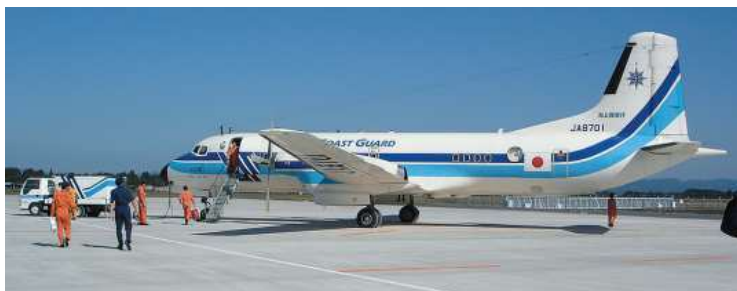
YS-11（JA8701） 機尾の突起（テールスティンガー）に プロトン磁力計が収納されている。 国旗前方にバブルウィンドウが見える。 出典：海上保安庁 海洋情報部技報
