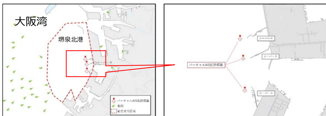
2022 年台風第 14 号接近時のバーチャル AIS 航路標識 表示イメージ（実際のレーダー画面を基に作図）
