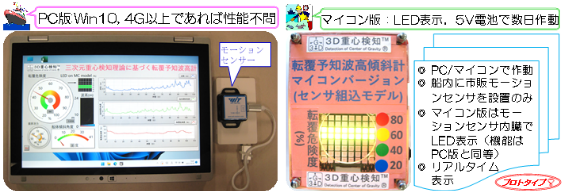
図1 三次元重心検知転覆予知波高計プロトタイプ (左: パソコン版, 右: マイコン版)
