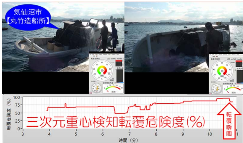
図3 三次元重心検知理論を実証した基礎実験（総トン数2トンの自走漁船）
