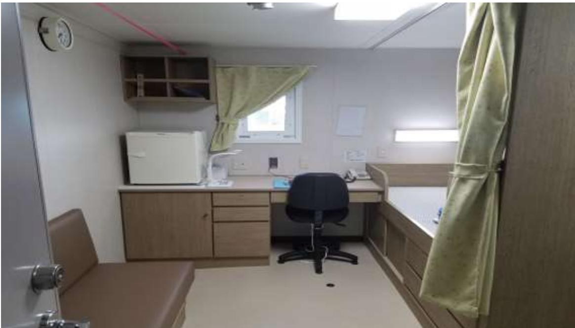
船室を入口から見たところですが、左からソファ、冷蔵庫、デスク、ベッドが見えます。冷蔵庫には船の揺れで扉が開かないようロックが付けられており、椅子の手前には同じく動揺で椅子が移動しないよう、ボルトで椅子を固定するためのナットが床に設けられているのが船らしいですね。改めて申しますが、全員個室です。
