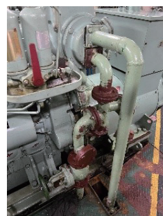
エンジン冷却装置を自作部品で直した船員と該当箇所（茶色部）
