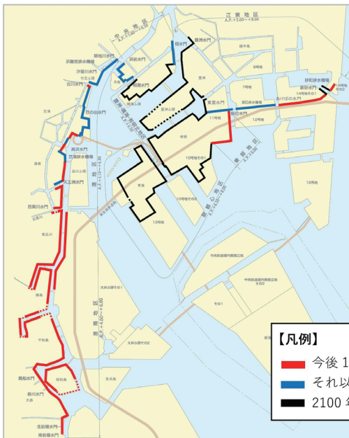
気候変動の影響に伴う防潮堤の高上げ位置図
