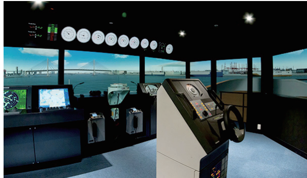
ビジュアル操船シミュレーター（写真提供：MOL マリン&エンジニアリング）
