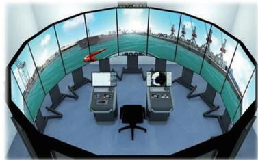
自動運転機能を搭載した次世代VRシミュレーター
