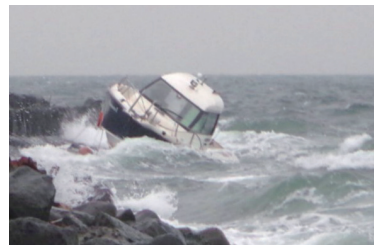
機関故障が原因で乗揚げた状況
