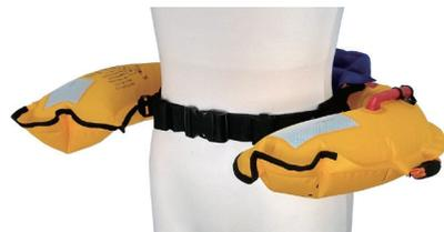
膨脹式ライフジャケットについては機械装置を搭載するため定期的なメンテナンスが必要です。使用頻度にもよりますが1年に1回程度、膨脹機構を作動させ気室を膨らませて1日程度放置し、空気漏れがないことを確認してからガスボンベなどを新品に交換すると良いでしょう。
