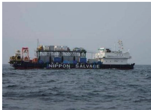
硝酸・重油を回収中の定点位置保持機能付き作業台船
