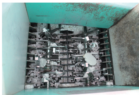
発泡スチロールを小さく砕く破砕機の内部
