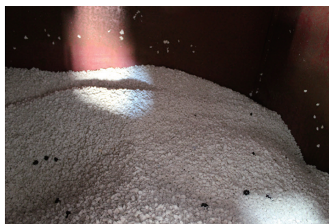
細かく砕かれた発泡スチロール（写真は貯蔵タンク内）
