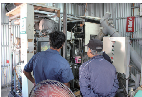
鳩間島に設置された油化装置
