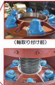
特殊車輪を使用した回転機構部
