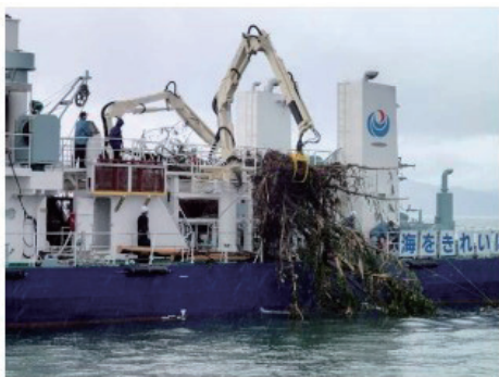
クレーンによる漂流物の回収状況
