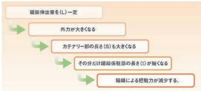
カテナリー長さや外力増加に伴う把駐力減少などの計算も、手計算では簡単にできません。これも外力 (風圧力) 計算同様、計算式を Excel File に入力しておくで、瞬時に結果が表示されます。
