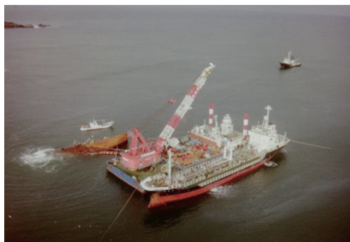
「ナホトカ号」船首部からの油抜き取り作業
