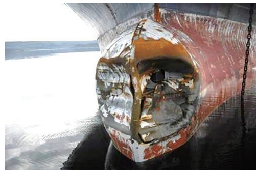
図6. 判定を見誤り損傷した船体 出典:カナダ沿岸警備隊ウェブサイト
