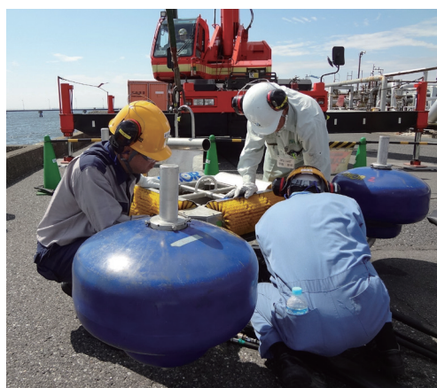
中型油回収機の組立て (実地操作訓練、国内第1号東京湾基地)
