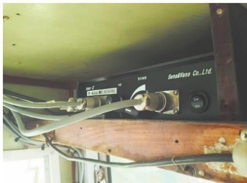
AIS搭載船に反応して搭載船の接近を光と音声で知らせる警報装置
