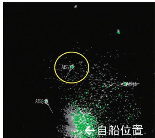
図3 レーダ映像と簡易型AISの重畳例
