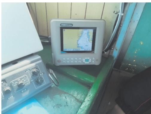
簡易型AISの設置に合わせて、設置されたAISプロッタ
