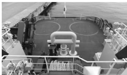
船橋上甲板から見た船尾甲板ロープリールと曳航フック
