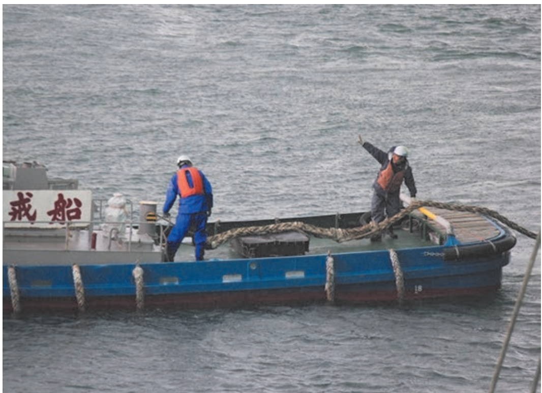
入港船より係船索を受け取り、陸上作業員に手信号で合図をしながら作業する係船ボート
