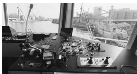
操縦スタンド右舷側ウィンドラス、アンカーなど操作盤
