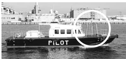
リギンが備え付けられているパイロットボート
