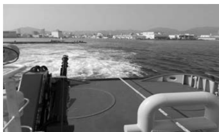
曳航ウィンチよりタグラインを出し曳引力計測中
