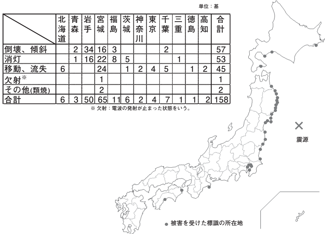
図1 海上保安庁が所管する航路標識の東北地方太平洋沖地震による被害
