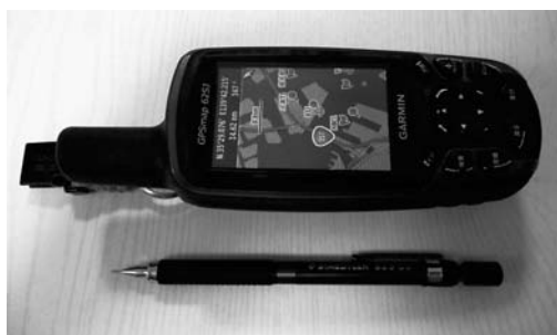
図1 携帯用 GPS (GARMIN 社製) 画面は横浜航路付近を表示
