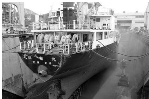
サンドブラストにより濛々とした粉塵が、本船を包んでドライドック全体に蔓延する
