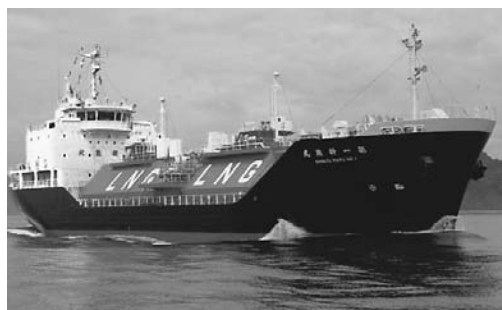
内航 LNG 運搬船 第一新珠丸 2,936総トン、2,513m 3
