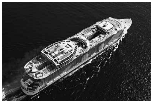
世界最大のクルーズ客船「オアシス・オブ・ザ・シース」(22万5,282総トン、全長: 361.0 m、全幅: 64.9 m、海面上高さ: 72.0 m)
