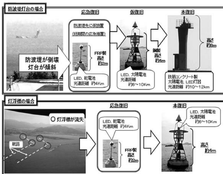
図2 東日本大震災で実施した段階的復旧
