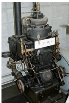
写真上左：機関実習室には懐かしい焼玉エンジンも
