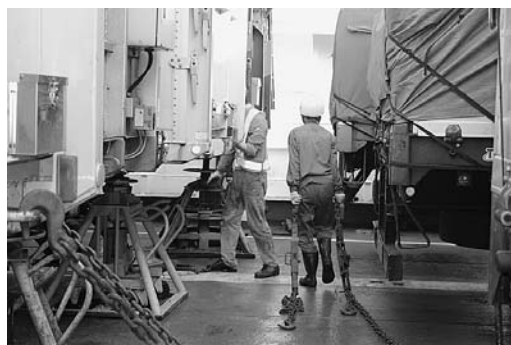
固縛用具の片付け作業に励む
