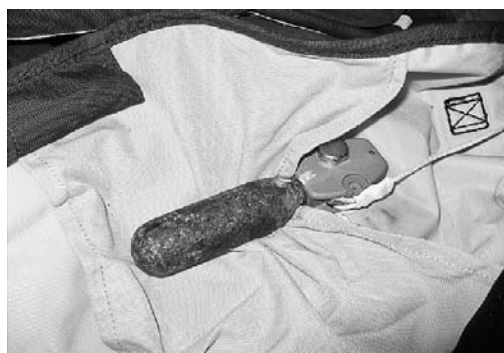
錆だらけで、安全ピンが抜けている使用済状態の膨脹式LJのボンベもあった。(筆者撮影)
