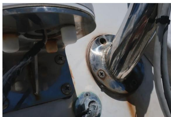
波による強い振動によりパトロール中にボルトが紛失
