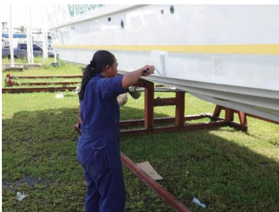
冷却水用保護垂鉛の取り付け
