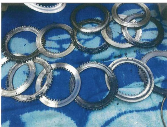
入力軸摩擦板・スチールプレートの焼損
