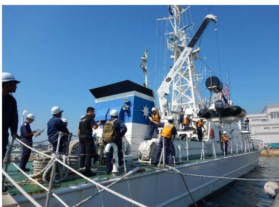
クレーンを使用した搭載艇揚げ降ろしの様子（くろかみ）
