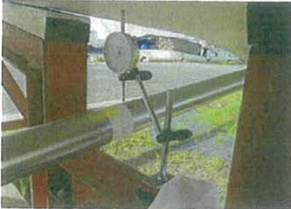
写真28：シャフト真直度計測風景2
