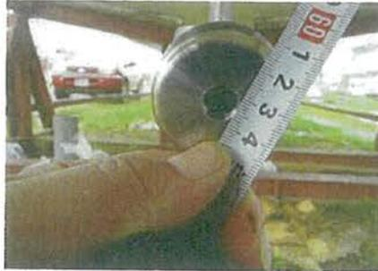
写真27：シャフト真直度計測風景1
