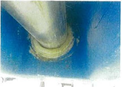
写真24：スタチューブ支面材交換後
