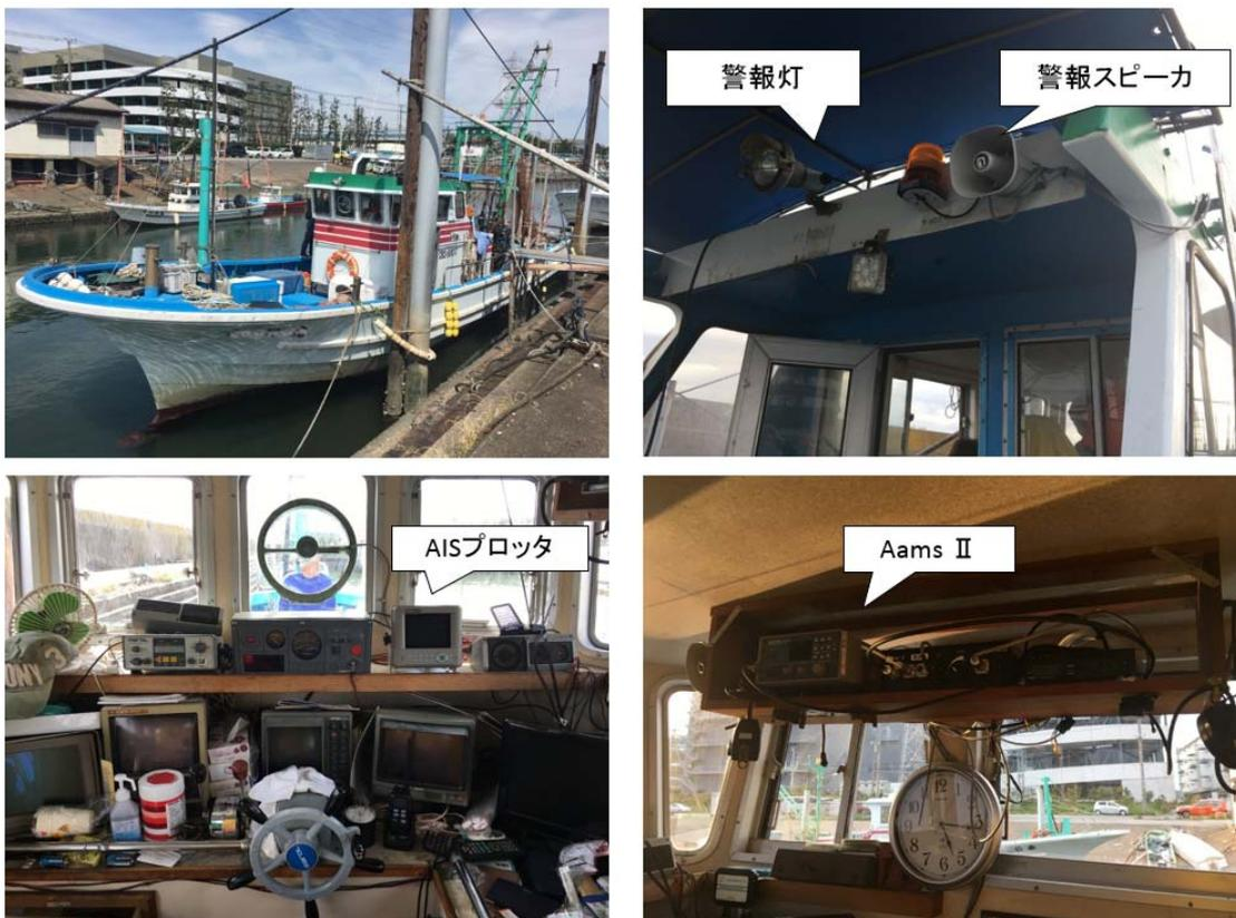
図 2.3.4 底引き網漁船 A 各機器設置状況
