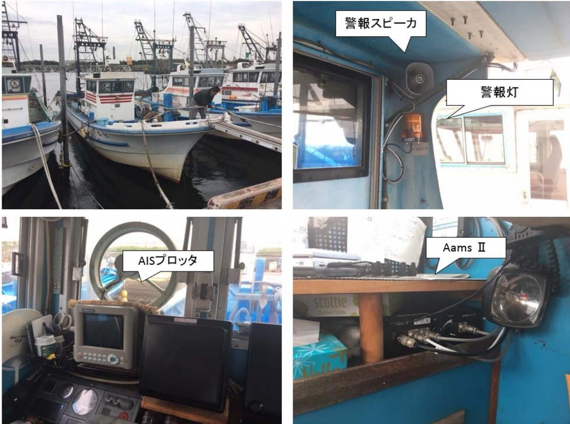
図 2.3.6 底引き網漁船 C 各機器設置状況
