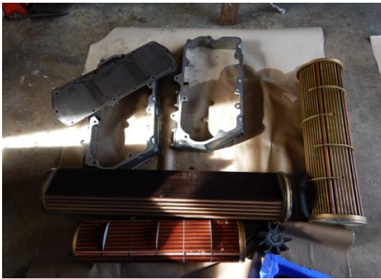
取外したインタークーラーコア、 清水クーラーコア、エンジンオイルクーラーコア
