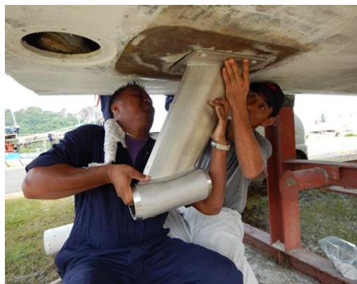
シャフトブラケット取付け部の調整
