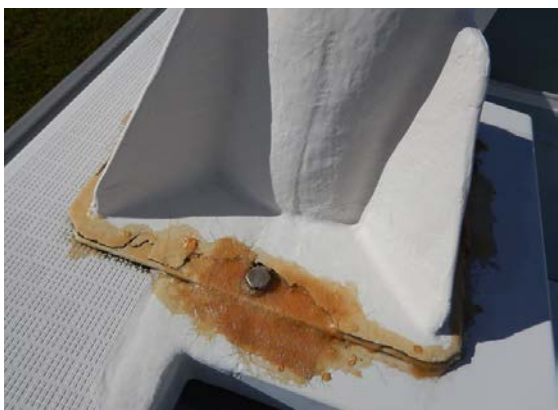
破損したアンテナブラケット
