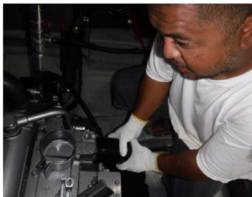
燃料フィルターの取外し
