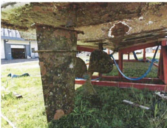
上架直後の汚損が激しいプロペラと舵
