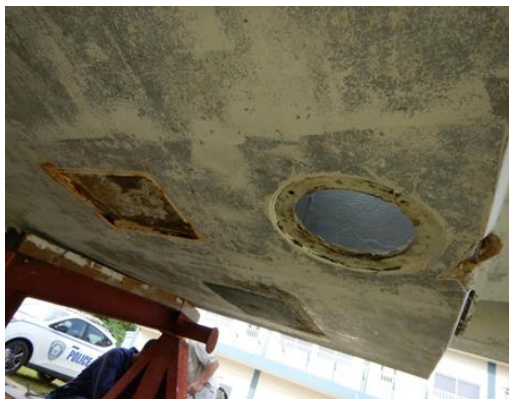
破損したシャフトブラケット 取付け部の内側
