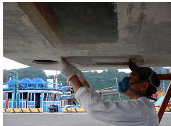
シャフトブラケット取付け部の修理
