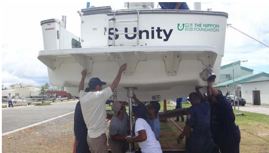
Unity 修理状況、舵挿入
