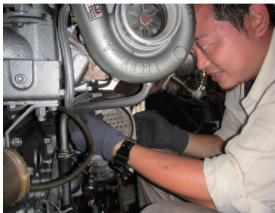
エンジンオイルクーラーコアの組み付け
