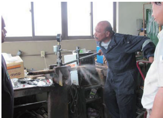
燃料噴射弁の圧力調整 (現地エンジニアによる作業の実施)
