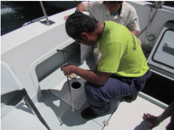
ラダーの作動確認 (サロン:油圧、FB:電気式)
