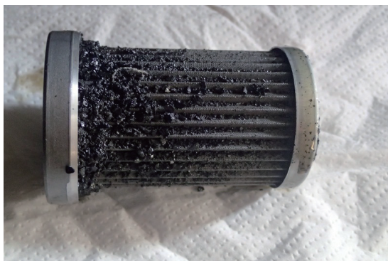
クラッチ板破片や鉄くずが付着したフィルター
