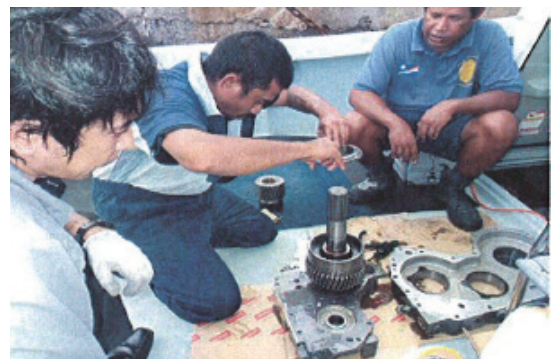
クラッチ板の取り外し・交換作業
