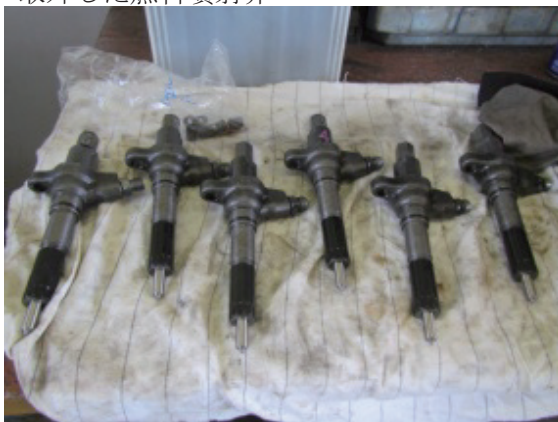
燃料噴射弁の交換・圧力調整方法指導
