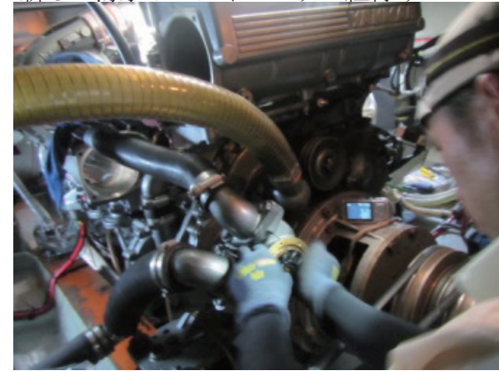
新しい海水ポンプインペラの組付け
