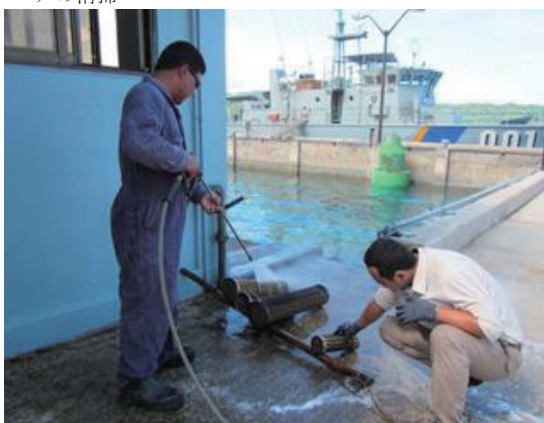
清水クーラーコア・エンジンオイルクーラーコア・ インタークーラーコア・ギアボックスオイルクーラー コアの清掃
