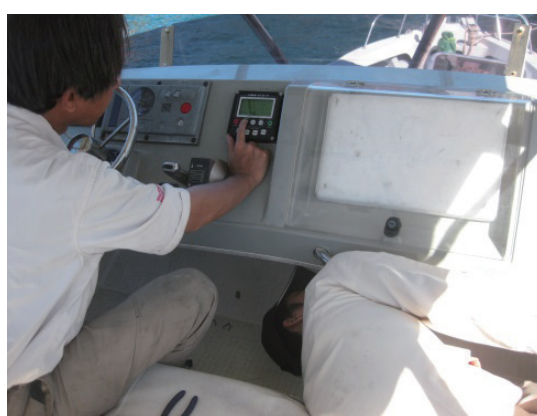
電気ステアリングの点検・調整
