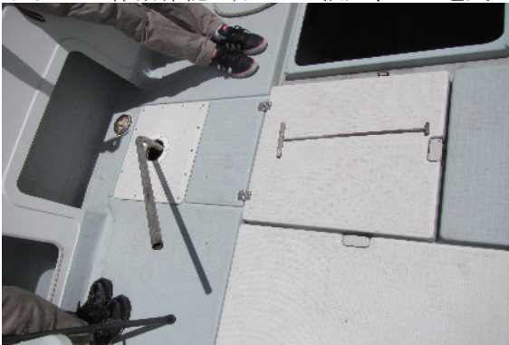
ラダーの作動確認 (サロン:油圧、FB:電気式)
