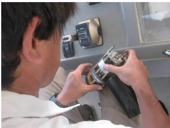
電気ステアリングの点検・調整
