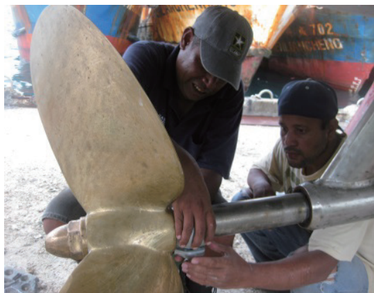
プロペラ亜鉛の組み付け
