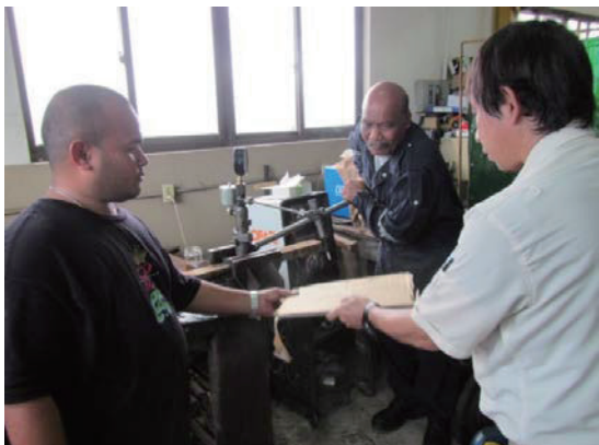
燃料噴射弁の噴射テスト
