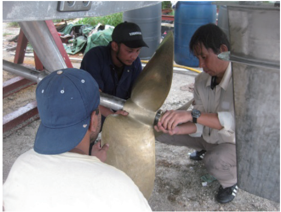
研磨後のプロペラ組み付け
