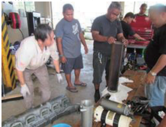
燃料噴射弁の取り外し後
