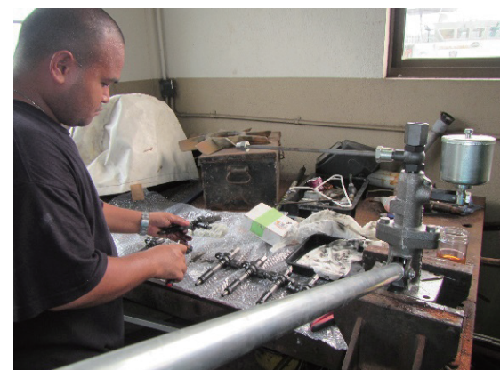
燃料噴射弁の圧力調整 (現地エンジニアによる作業の実施)
