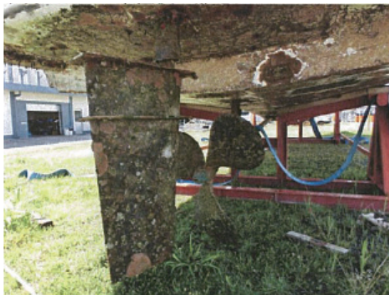
上架直後の汚損が激しいプロペラと舵
