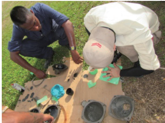
インタークーラーカバー・亜鉛の清掃・塗装
