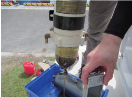
取り外した油水分離器（汚れが溜まった状態）
