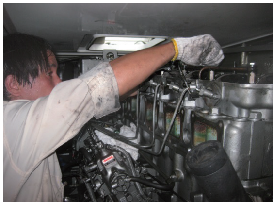
燃料噴射弁の組み付け
