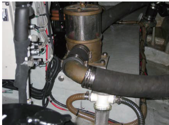
海水フィルター組み付けと エアコン用海水コシキ交換後
