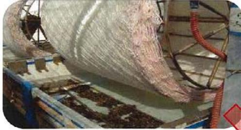
貝殻に付いた胞子を車輪に巻き付けた網に付着させます。（陸上で行います。）
