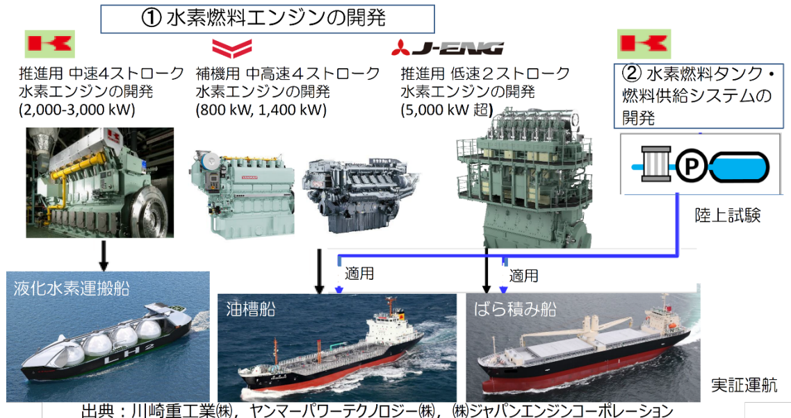
【図 7】 舶用水素エンジン及び舶用水素燃料タンク・燃料供給システムの開発
