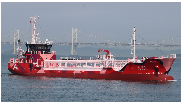
出典：旭タンカー（株）提供 竣工した電気推進タンカー「あさひ」（2022 年 3 月）
