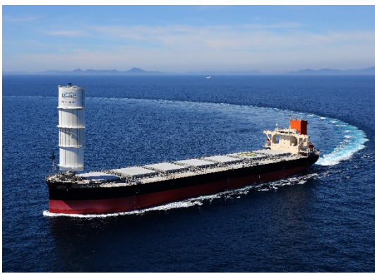
出典：（株）商船三井・東北電力（株）提供 硬翼帆推進装置搭載船「松風丸」
