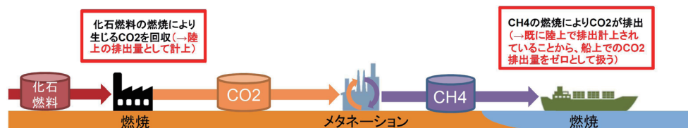
【図 13】船上での CO 2 排出をゼロとして扱うことの検討参考図
