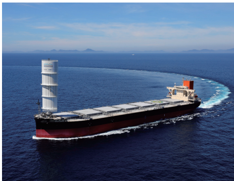
出典：（株）商船三井・東北電力（株）提供 硬翼帆推進装置搭載船「松風丸」
