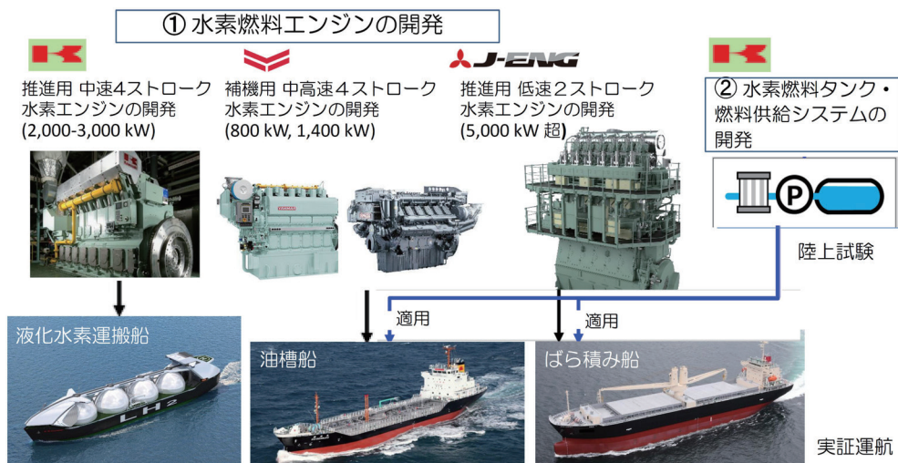
【図 7】船用水素エンジン及び船用水素燃料タンク・燃料供給システムの開発
