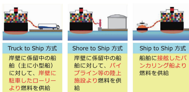
【図 12】船舶への燃料供給（バンカリング）の形態
