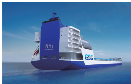
図4 AiP取得船（アンモニア燃料パナマックスバルクキャリア）のイメージ図、概略要目
